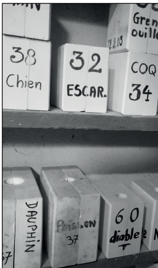
Quelques moules servant à fabriquer les pipes
